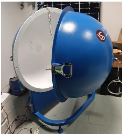
Figura 14. Sfera integratrice utilizzata per la caratterizzazione delle schede LED assemblate.
